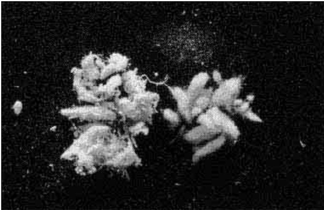
28. (sotto) "Granulati" (cioè fibre in aggregati dall'aspetto granulare) di crisotilo e di fibra ceramica (rispettivamente a sinistra e a destra)
