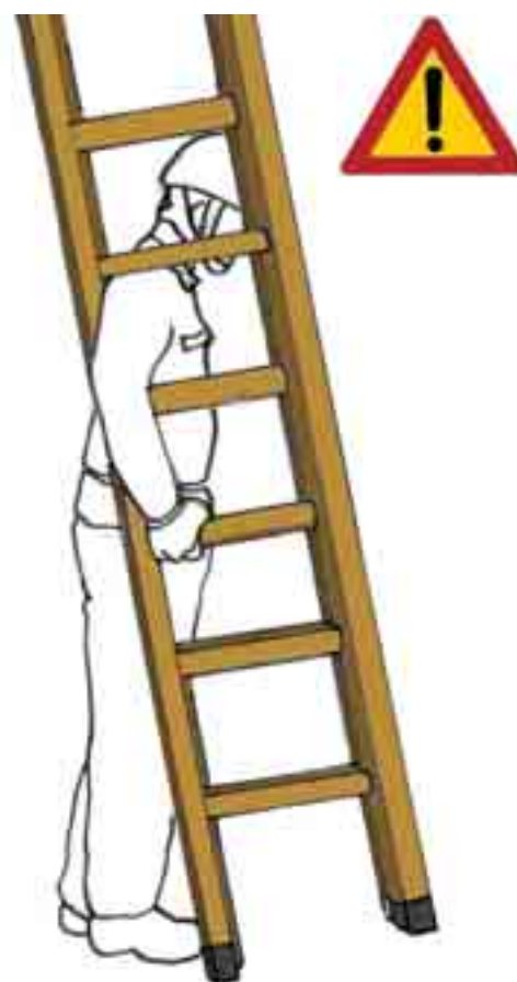
Fig. 6 - Modalità errata di trasporto della scala a spalla
