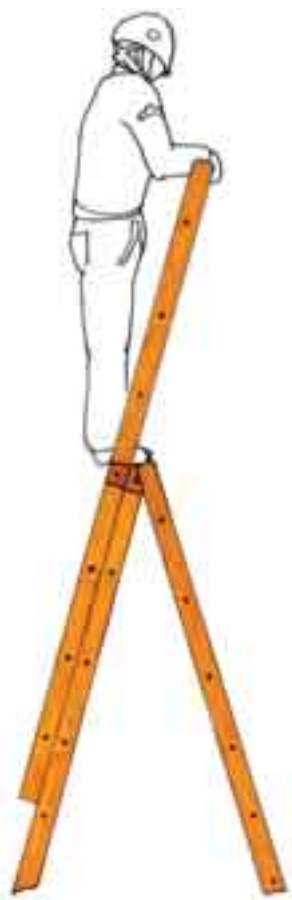
Fig. 49 - Massima altezza di salita in una scala trasformabile
