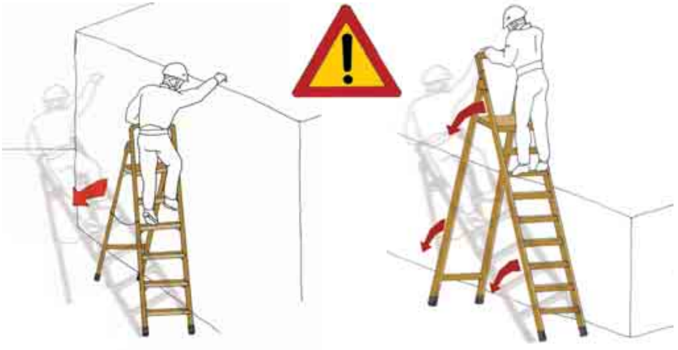
Fig. 4 - Erroneo uso della scala: posizione laterale e sistema di accesso ad altro luogo
